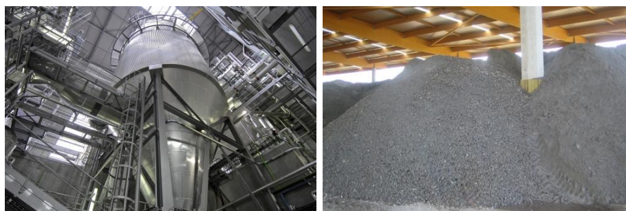
Unité de traitement des fumées et mâchefers stockés pour la filière routière
