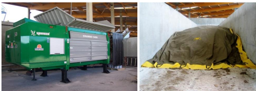
Dispositif de broyage des biodéchets et stockage en alvéole sous bâche.
