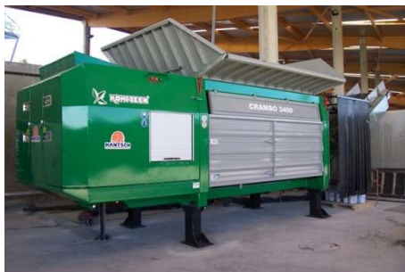
Dispositif de broyage des biodéchets et stockage en alvéole sous bâche.
