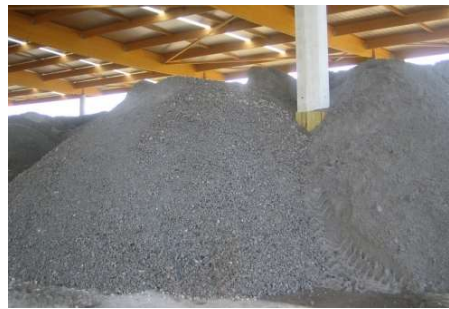
Unité de traitement des fumées et mâchefers stockés pour la filière routière
